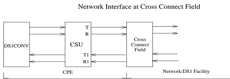
**Figure 9-26. DS1 Facility Connections**
