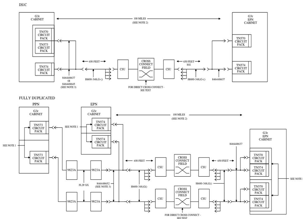
Figure 2-3. Typical DS1 CONV Connections to Remote EPNs
