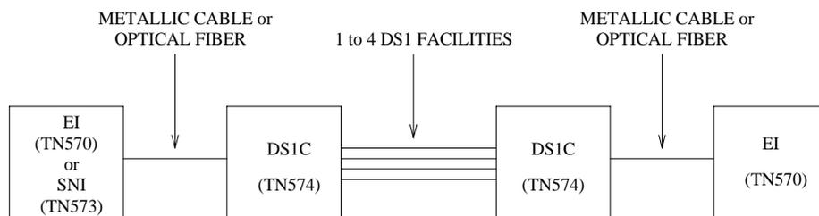
Figure 9-39. Fiber Link with DS1 Converter Complex
