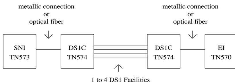
Figure 9-89. Fiber Link over a DS1 Converter Complex
