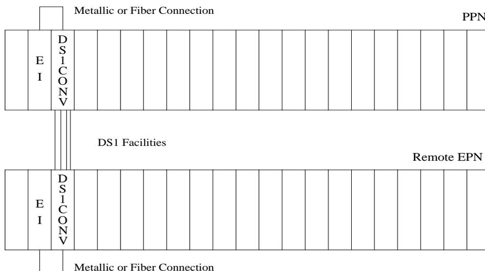
Figure 9-31. DS1 CONV Complex in Direct Connect PNC
