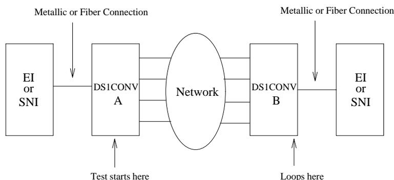
Figure 9-33. Far-end DS1 CONV Loopback Test (#788)
