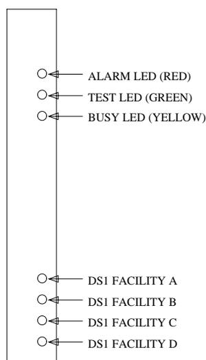
Figure 7-3. TN574 DS1C Circuit Pack LEDs
